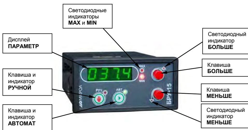
Рисунок 3.2 - Внешний вид передней панели блока ручного управления БРУ-15
