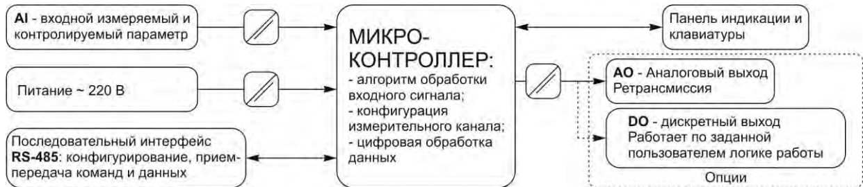
Рисунок 3.2 - Структурная схема амперметра ИПМ-3
