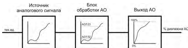
Рисунок 3.6 – Работа блока аналогового вывода в режиме ретрансмиссии
