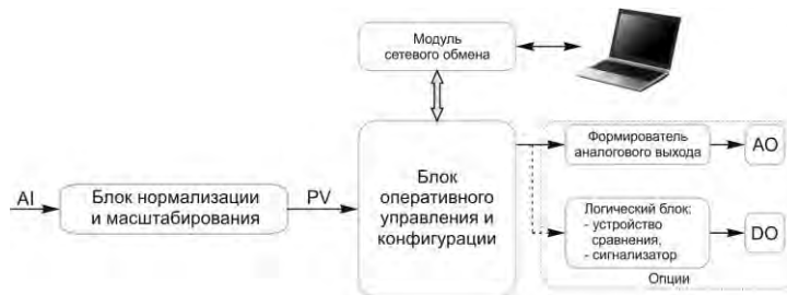
Рисунок 3.3 - Функциональная схема амперметра ИПМ-3
