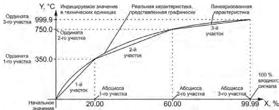
Рисунок 3.5 – График линеаризованного сигнала
